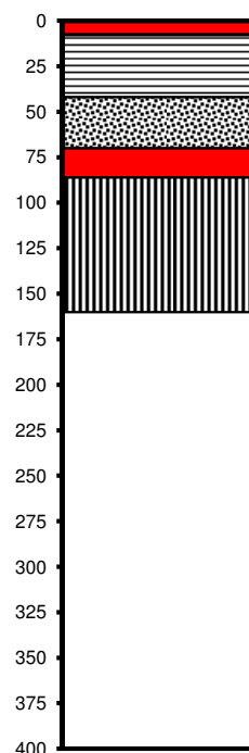
grafische laagopbouw asfaltconstructie
