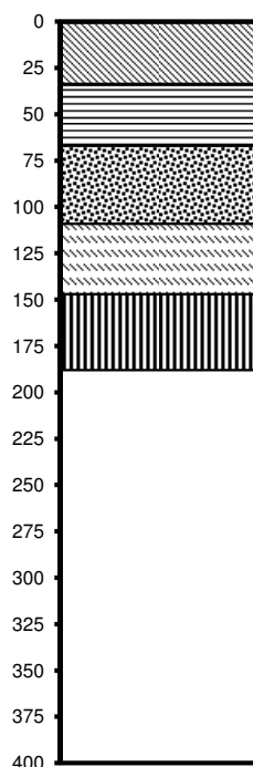
grafische laagopbouw asfaltconstructie
